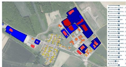
Figure 2 : Exemple vue des emplacements de parkings pour ombrière et du potentiel des toitures via le portail IGN
